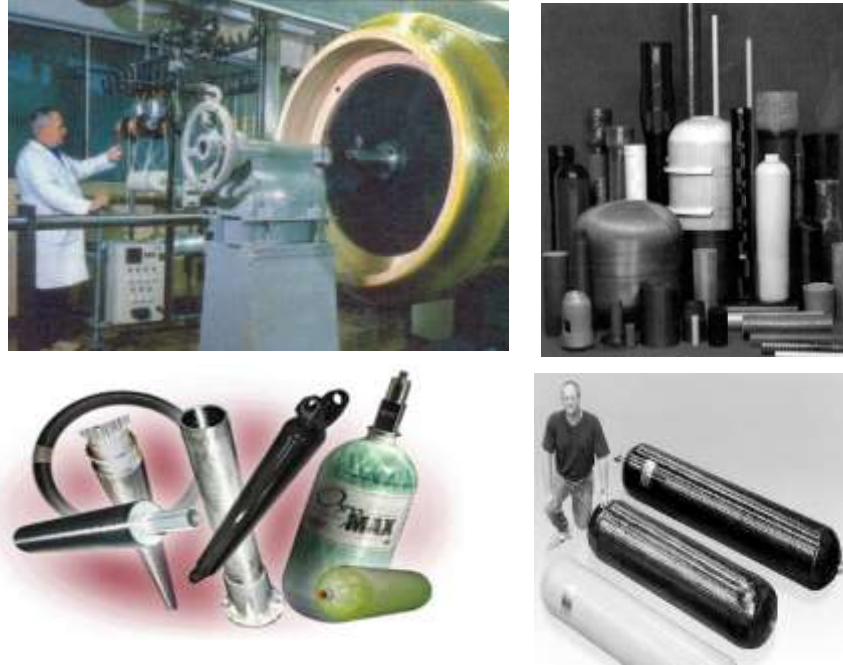
Şekil 38. Filament/Elyaf sarma yöntemi ile üretilen kompozit malzemeler
