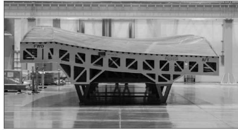
Şekil 46. AV-8B kanat bölümünün karbon fiber-epoksi laminatı kesilerek kürlenmesi için otoklava yerleştiriliyor
