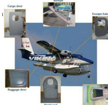
Şekil 40. Reçine transfer kalıplama yöntemi ile üretilen kompozit malzemeler
