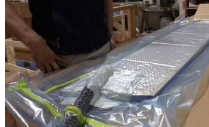
Şekil 43. Vakum torbalama yöntemi [49,50]
