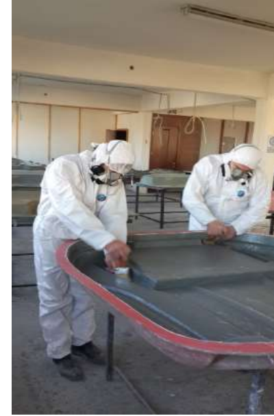
Şekil 34. Elle yatırma yöntemi ile üretilen kompozit malzemeler
