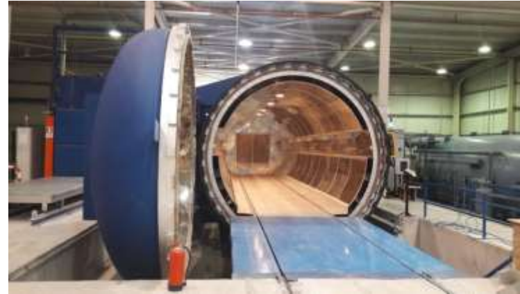
Şekil 45 . Otoklav+Vakum torbalama yöntemi [51,52]
