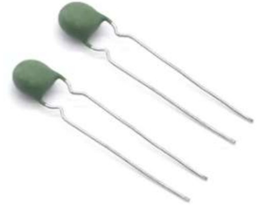
Şekil 12. 600-800 Ohm Termistörler Aşırı Akım Koruması [17]
