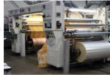
Şekil 51. Sürekli laminasyon yöntemi [47,55]
