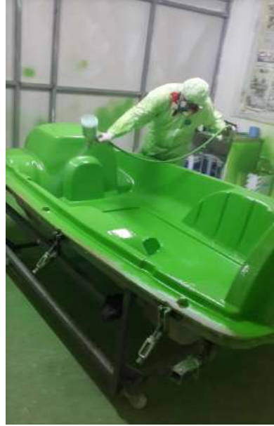
Şekil 34. Elle yatırma yöntemi ile üretilen kompozit malzemeler
