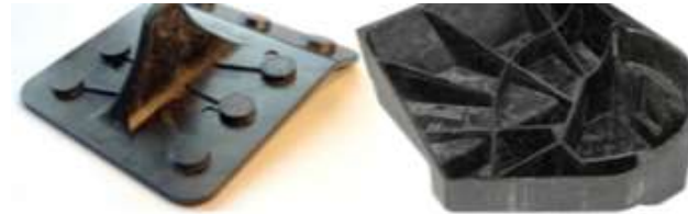
Şekil 48. Sıcak Presleme yöntemi ile üretilen kompozit malzemeler
