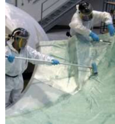
Şekil 33. Elle yatırma yöntemi [40,41]
