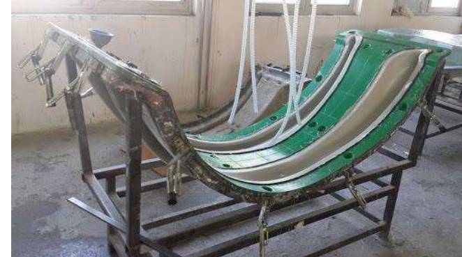
Şekil 39 . Reçine transfer kalıplama yöntemi [46,47]
