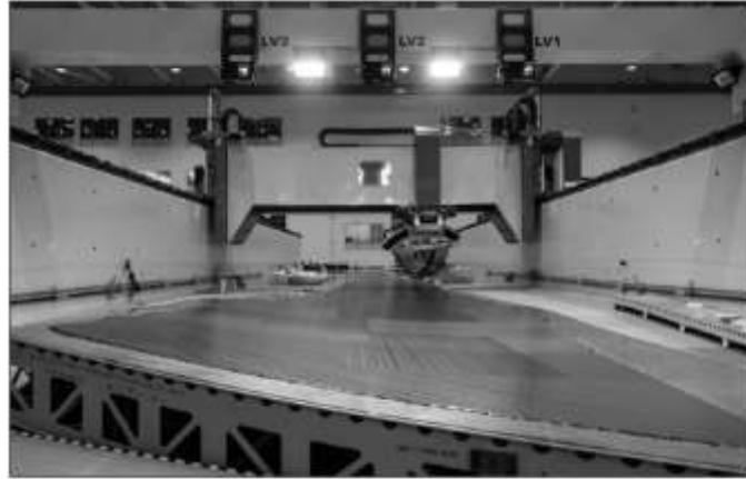
Şekil 46. AV-8B kanat bölümünün karbon fiber-epoksi laminatı kesilerek kürlenmesi için otoklava yerleştiriliyor
