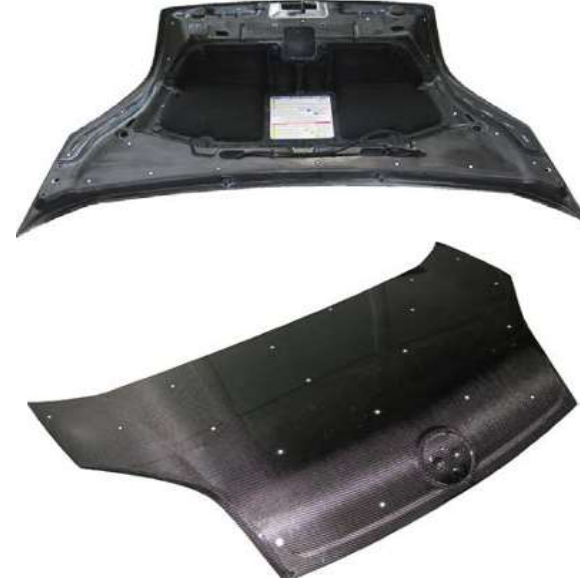
Şekil 42. Vakum infüzyon yöntemi ile üretilen kompozit malzemeler
