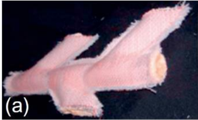
Çeşitli liflerden yapılmış boğum yapıları. (a) Polyester. (b) Cam. (c) Karbon. Taylor (2007).
