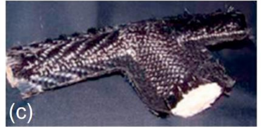
Çeşitli liflerden yapılmış boğum yapıları. (a) Polyester. (b) Cam. (c) Karbon. Taylor (2007).
