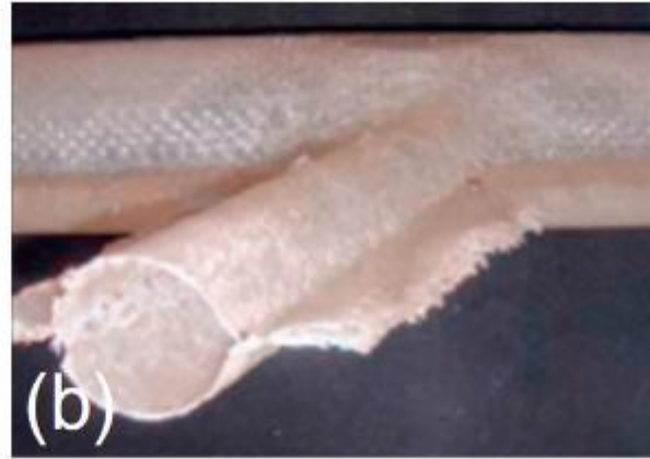
Çeşitli liflerden yapılmış boğum yapıları. (a) Polyester. (b) Cam. (c) Karbon. Taylor (2007).
