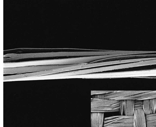
Fibrillenmiş şerit kumaşı gösteren taramalı elektron mikroskop görüntüsü
